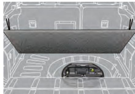
L'anneau de remorquage est installé dans le coffre sous le plancher.
