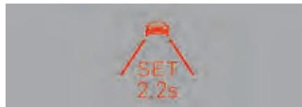
La valeur d'alerte est programmable entre 0,9 seconde et 2,5 secondes. L'alerte visuelle peut être désactivée en programmant une valeur de 0 seconde.
