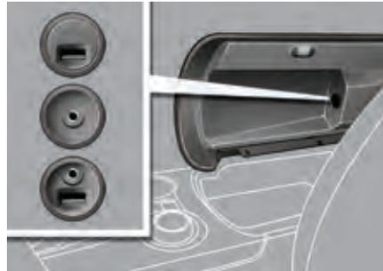
Ce boîtier de connexion est composé d'une prise JACK et/ou d'un port USB.
