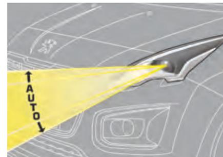
Pour ne pas gêner les autres usagers de la route, ce système corrige, automatiquement et à l'arrêt, la hauteur du faisceau des lampes au xénon, en fonction de la charge du véhicule.
