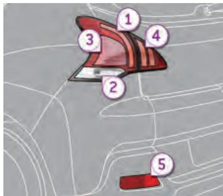
1. Feux de stop / position (diodes électroluminescentes-LED).
