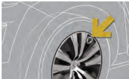
Système assurant le contrôle automatique de la pression des pneumatiques en roulant.
