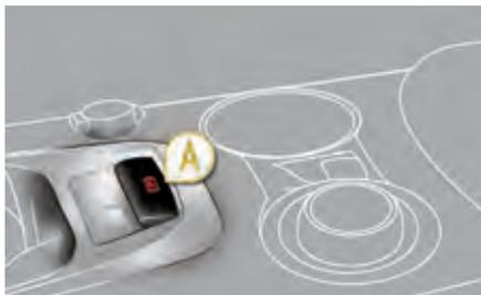
Véhicule à l'arrêt, pour serrer le frein de stationnement, moteur tournant ou arrêté, **tirez** sur la palette **A**.
