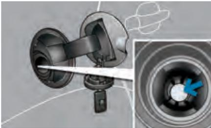
Lors de son introduction dans votre réservoir Diesel, le pistolet essence vient buter sur le volet. Le système reste verrouillé et empêche le remplissage.
