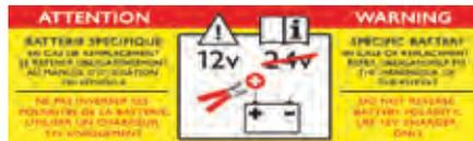
**i** La présence de cette étiquette, notamment avec le Stop & Start, indique l'utilisation d'une batterie au plomb 12 V de technologie et de caractéristiques spécifiques, qui nécessite, en cas de remplacement ou de débranchement, l'intervention exclusive du réseau PEUGEOT ou d'un atelier qualifié.
