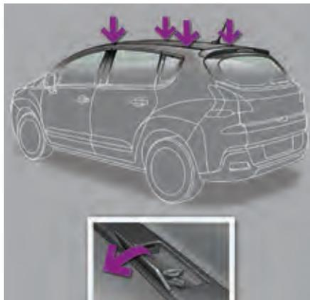
Pour installer des barres de toit transversales, utilisez les quatre fixations rapides prévues à cet effet :
