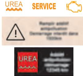
A chaque mise du contact, les témoins SERVICE et autodiagnostic moteur s'allument et le témoin UREA clignote, accompagnés d'un signal sonore et de l'affichage du message "Défaut antipollution : Démarrage interdit".
