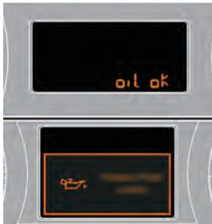
**i** Toute vérification de ce niveau n'est valable que si le véhicule est sur un sol horizontal, moteur à l'arrêt depuis plus de 30 minutes.
