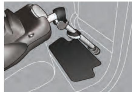
Une autre possibilité, lorsque la béquille est assez longue et s'incline suffisamment (tout en respectant les recommandations données dans la notice d'installation du siège enfant), est de positionner la béquille pour qu'elle soit en contact avec le plancher en dehors de la zone de coffre. Pensez à utiliser le réglage longitudinal du siège arrière ou du siège avant pour obtenir une position de la béquille satisfaisante et en dehors de la zone de coffre.
