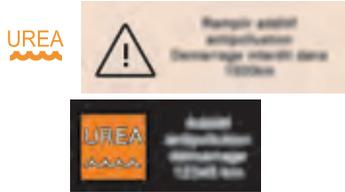
Dès la mise du contact, le témoin UREA s'allume, accompagné d'un signal sonore et de l'affichage d'un message (ex : "Remplir additif antipollution : Démarrage interdit dans 1 500 km") indiquant l'autonomie de roulage exprimée en kilomètres ou miles.
