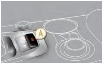
En cas de défaillance du freinage par la pédale de frein ou en situation exceptionnelle (exemple : malaise du conducteur, en conduite accompagnée, ...), **un tirage maintenu de la palette A permet d'arrêter le véhicule.**
