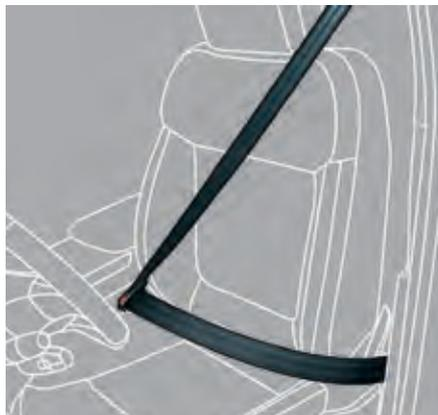
Les ceintures de sécurité avant sont équipées d'un système de prétension pyrotechnique et de limiteur d'effort.
