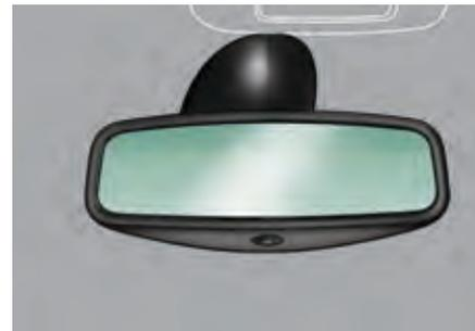
Grâce à un capteur, mesurant la luminosité provenant de l'arrière du véhicule, ce système assure automatiquement et progressivement le passage entre les utilisations jour et nuit.
