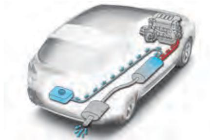
L'additif AdBlue® est contenu dans un r servoir sp cifique, situ  sous le coffre,   l'arri re du v hicule. Sa contenance est de 17 litres : elle permet une autonomie de roulage d'environ 20 000 km avant le d clenchement d'un dispositif d'alerte qui vous avertit d s que le niveau de r serve vous permet de parcourir 2 400 km.
